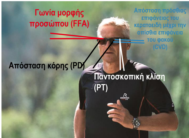
Εικόνα 4: Μεμονωμένες παράμετροι της κατάστασης φθοράς
