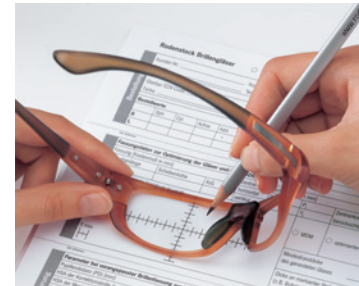
Abbildung 5-8: Abzeichnen der Scheibenform einer Sportfassung
