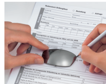
Abbildung 5-9: Abzeichnen der Scheibenform anhand des Brillenglases
