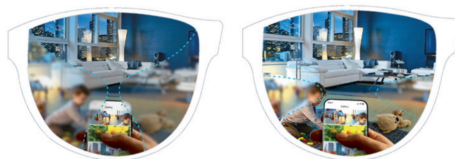
Abbildung 1-26: Einschränkungen in den Sehbereichen durch den Basiskurveneffekt (links), keine Einschränkungen (rechts)
