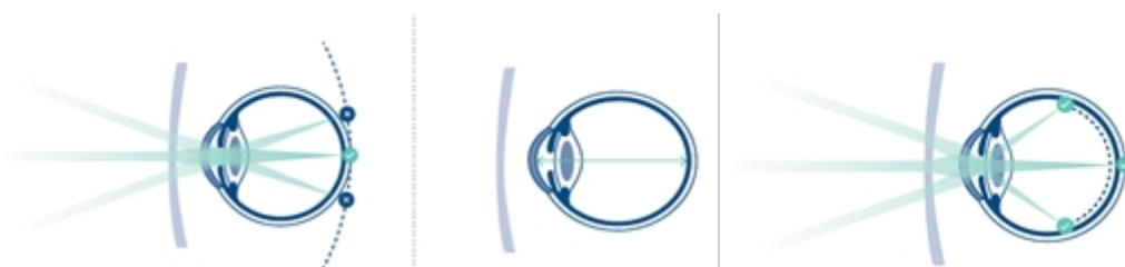
Abbildung 3: Sehen mit herkömmlichen Einstärkengläsern (links). Durch die periphere Unschärfe kann ein Wachstumsreiz ausgelöst werden, an den sich manche Augen durch ein verstärktes Längenwachstum anzupassen versuchen (Mitte). Mit Myopie Management Brillengläsern wird das Licht in der Peripherie des Glases so gebrochen, dass es vor der Netzhaut auftrifft, was das Augenwachstum verlangsamt (rechts).
