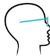
Abbildung 6: Kopfhaltung bei Anpassung nach Augendrehpunktforderung
